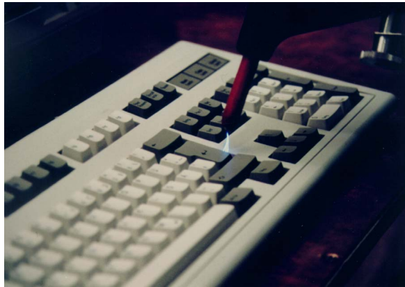
Störfestigkeitsprüfung der Entladung statischer Elektrizität im Labor.
